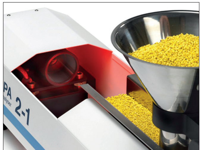
HAYER CPA 2-1 bei der Vermessung von Kunststoffgranulat
