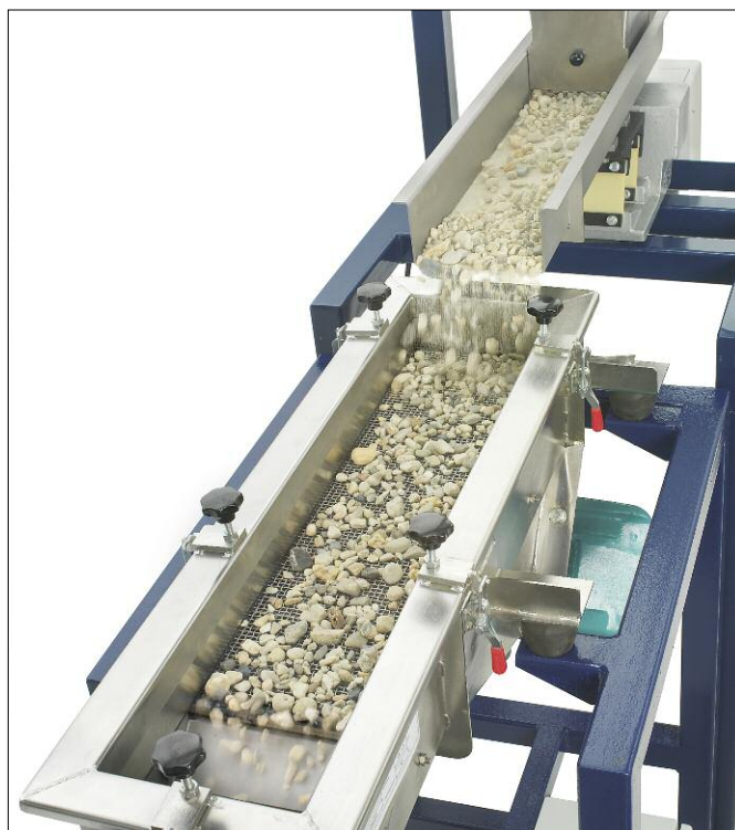
HAYER DMS Siebmaschine, kombiniert mit HAYER EMZ Förderrinne, bei der Vorabsiebung von Sand und Kies
